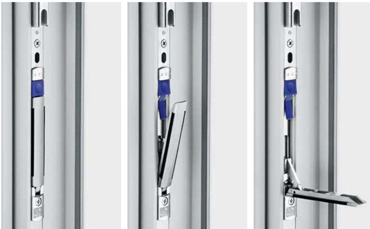
Díky výraznému modrému tlačítku pro odblokování uzavíracího mechanismu v pasivním křídle štolpového okna lze druhé křídlo snadno otevřít.
